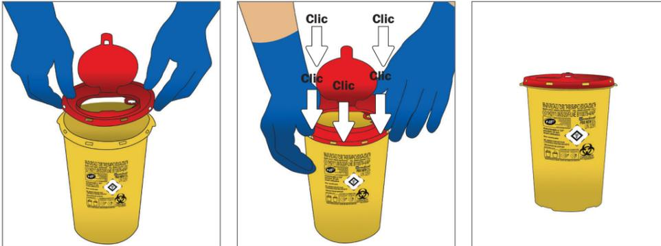
Positionner le couvercle sur le récipient avec l'orifice d'introduction des déchets côté marquage. Presser tout autour du couvercle avec la paume de la main, jusqu'à entendre les 8 déclics
