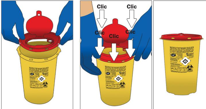
Positionner le couvercle sur le récipient avec l'orifice d'introduction des déchets côté marquage. Presser tout autour du couvercle avec la paume de la main, jusqu'à entendre les 8 déclics
